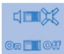
V blízkosti krytu na baterie se nachází dva posuvné přepínače. První slouží k zapnutí/vypnutí zvuku, druhý k zapnutí/vypnutí robota. Při běžném používání jsou oba v poloze zapnuty.
